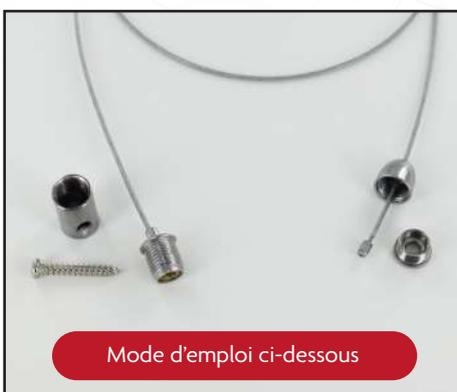
Assemblez le kit de suspension comme indiqué ci-dessus. Insérez la vis à travers la pièce en forme de cylindre tandis que l'extrémité du fil avec une goupille à bille doit être transformée en un petit crochet à l'extérieur de la pièce arrondie. Vous pouvez affiner la longueur du câble à l'aide du petit trou dans la pièce en forme de cylindre.
